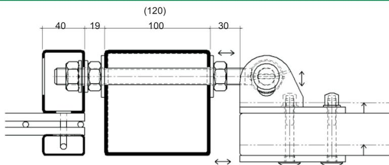
Zur Justierung des Torflügels nutzen Sie bitte die Umsteckmöglichkeit der Augenschrauben sowie die Verstellmöglichkeiten über das Augenschraubengewinde.
